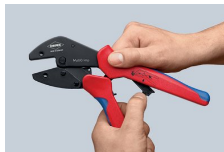
Bytesposition: Fäll ut servicespaken för parallellt backläge
