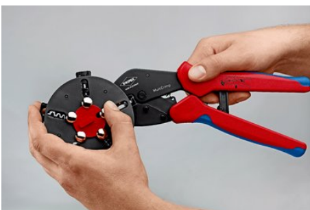
Pressbacksbyte: Läs upp magasinpositionen, ta ut pressbacken ur magasinet
